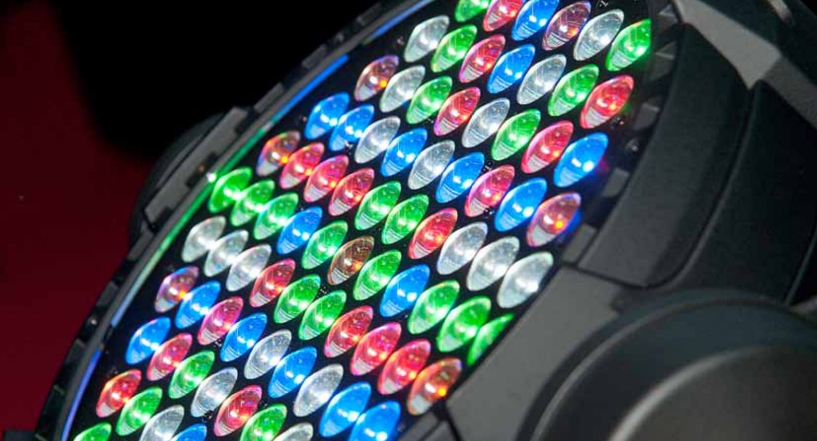
Ledarmatuur met witte, blauwe, groene en rode leds. | FOTO: © BASTIAAN HOPSTER |
